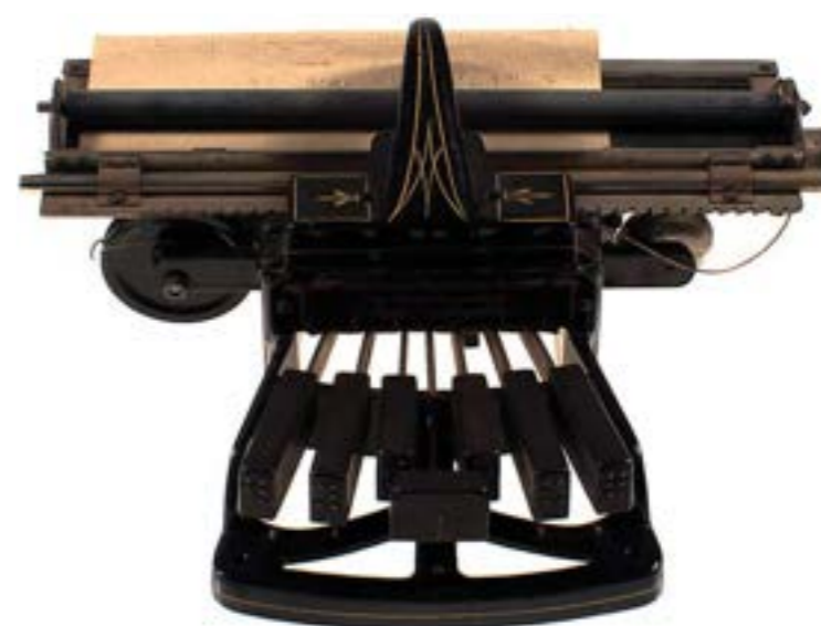
Pichtův psací stroj byl patentován roku 1901. Třicet let po smrti vynálezce slepeckého písma Louise Braillova pomohl jeho vynález do světa. Repr. KT
